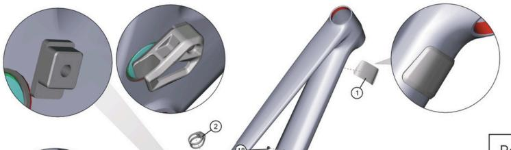
Hinweis: Bei den Schrauben muss mittelfeste Gewindesicherung verwendet werden. Rote Flächen müssen ge-
